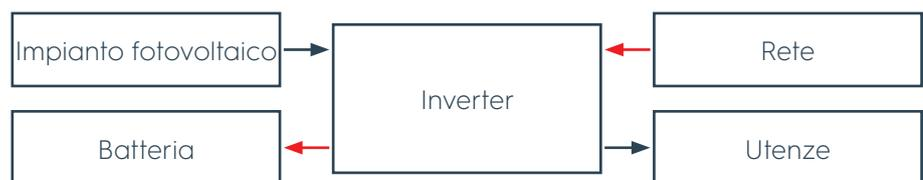
**Figura 25** Energia fotovoltaica insufficiente ed energia aggiuntiva per le utenze prelevata dalla rete
