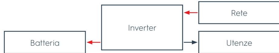
**Figura 32** Energia per la ricarica della batteria e le utenze prelevata dalla rete
