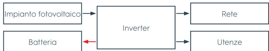
**Figura 24** Energia fotovoltaica sufficiente ed energia in eccesso riservata alle utenze ed immessa nella rete
