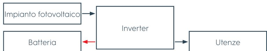
**Figura 22** Energia fotovoltaica sufficiente ed energia in eccesso riservata alla ricarica della batteria
