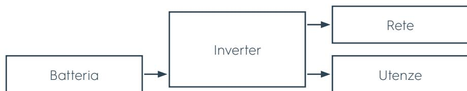
**Figura 28** Energia prelevata dalla batteria sufficiente ed energia in eccesso immessa nella rete
