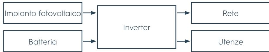
**Figura 26** Batteria carica, energia fotovoltaica sufficiente, energia in eccesso ed energia prelevata dalla batteria ed immessa nella rete
