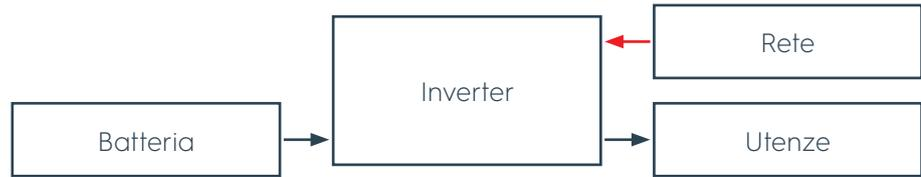
**Figura 29** Energia prelevata dalla batteria insufficiente ed energia prelevata dalla rete
