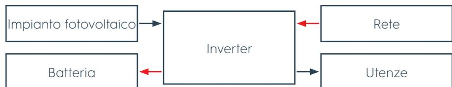
**Figura 31** Energia fotovoltaica insufficiente ed energia aggiuntiva per le utenze prelevata dalla rete
