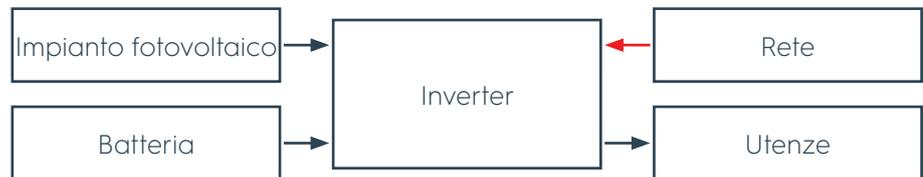
**Figura 21** Energia prodotta e batteria insufficienti viene prelevata energia aggiuntiva dalla rete
