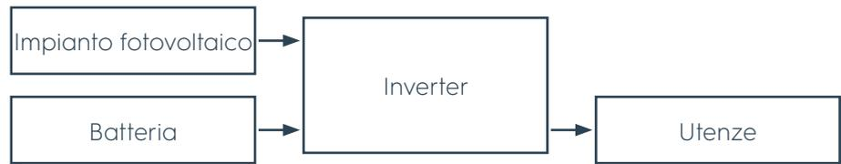
**Figura 23** Energia fotovoltaica insufficiente ed energia aggiuntiva prelevata dalla batteria
