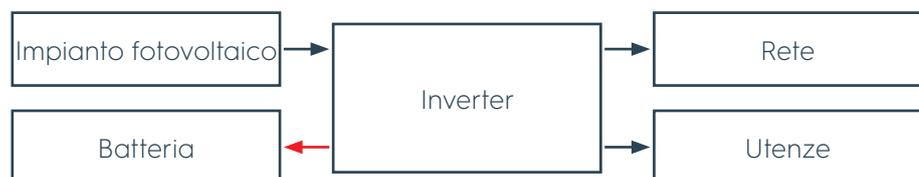
**Figura 19** Energia fotovoltaica sufficiente ed energia in eccesso riservata alla ricarica della batteria ed immessa nella rete
