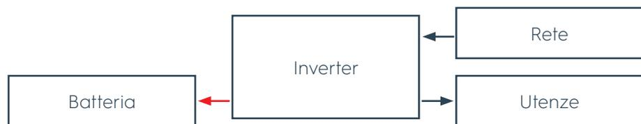
**Figura 27** Energia per la ricarica della batteria dalla rete
