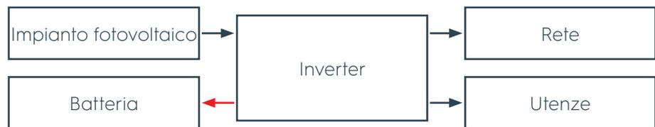
**Figura 30** Energia fotovoltaica sufficiente ed energia in eccesso riservata alle utenze ed immessa nella rete
