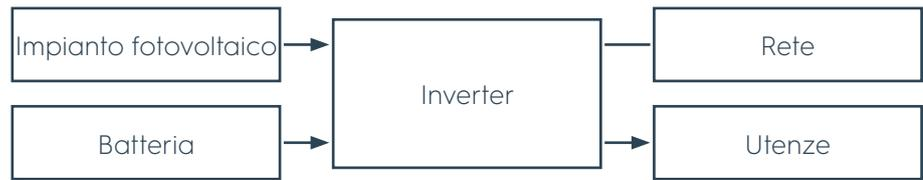
**Figura 20** Energia fotovoltaica insufficiente ed energia aggiuntiva prelevata dalla batteria
