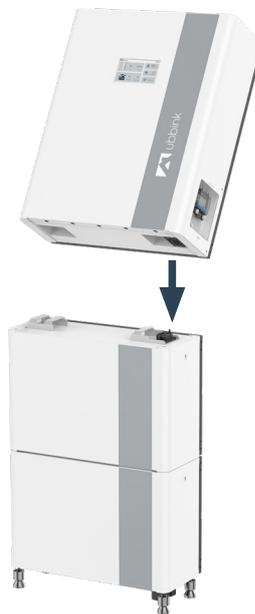
**Figura 36** Montaggio dell'inverter sul modulo batteria
