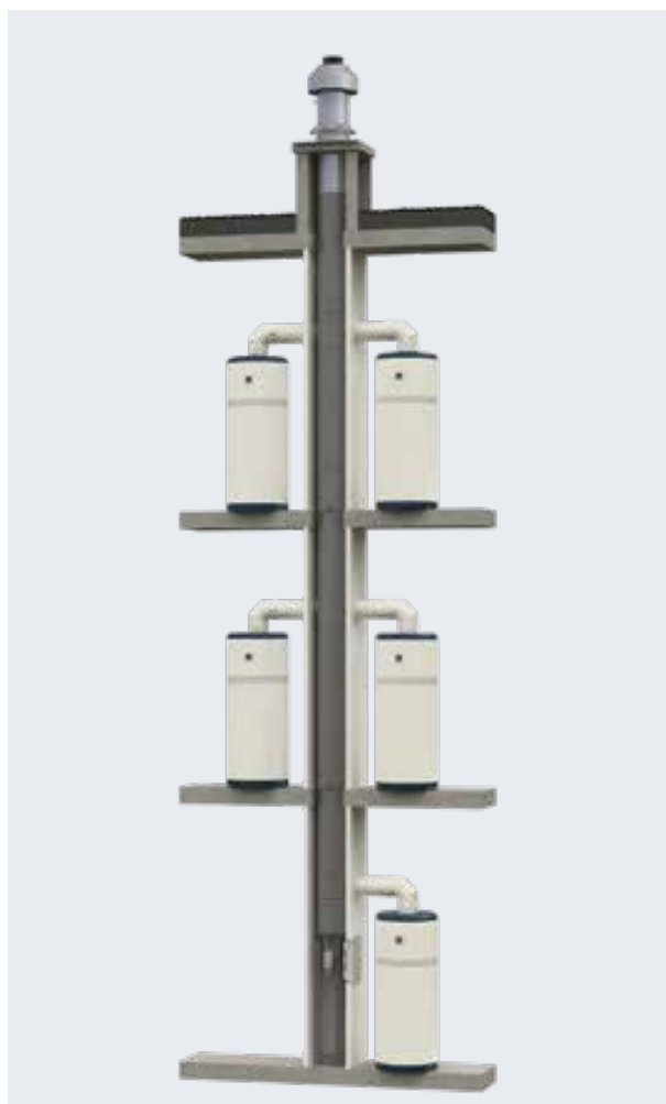
Installation en gaine technique*. Appareils installés dans le logement.
