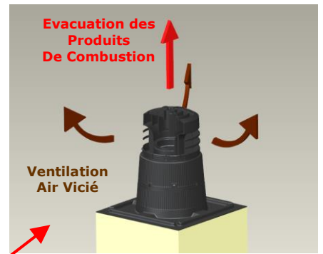
Figure 5b- Débouché de conduit de fumée existant et terminal
