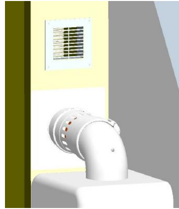
Figure 6b : Ventilation Permanente par Pièce Kit R'1 OPTION 2 : grille de Ventilation, non intégrée à une plaque de finition
