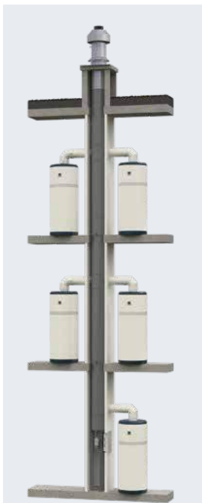
Installation en gaine technique*. Appareils installés dans le logement.
