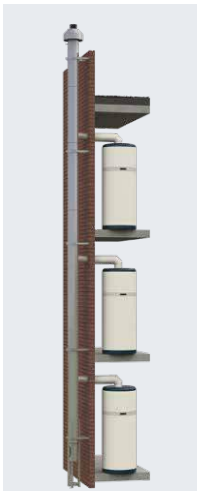
Installation extérieure. Appareils installés dans le logement.
