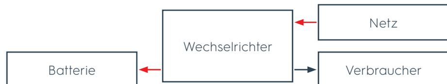
**Bild 32** Energie für Batterieladung und Verbraucher aus dem Netz
