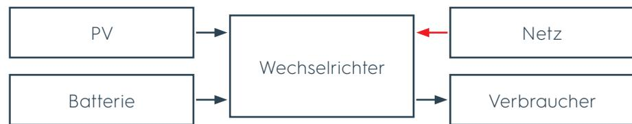
**Bild 21** Solarenergie und Batterie nicht ausreichend, zusätzliche Energie aus dem Netz
