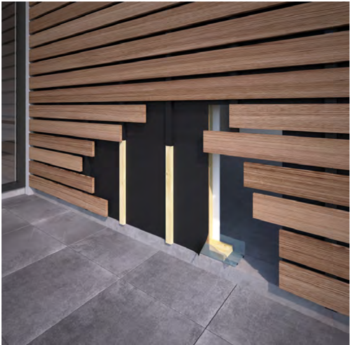
Multivap UV intégré dans la façade.
